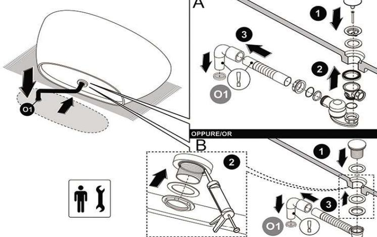
3. Установите трубу для слива и автоматическую пробку слива в соответствии со схемой на рисунке.
