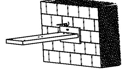
10. Прочно зафиксируйте конструкцию винтами M6(8шт.) с помощью шестигранного ключа..
