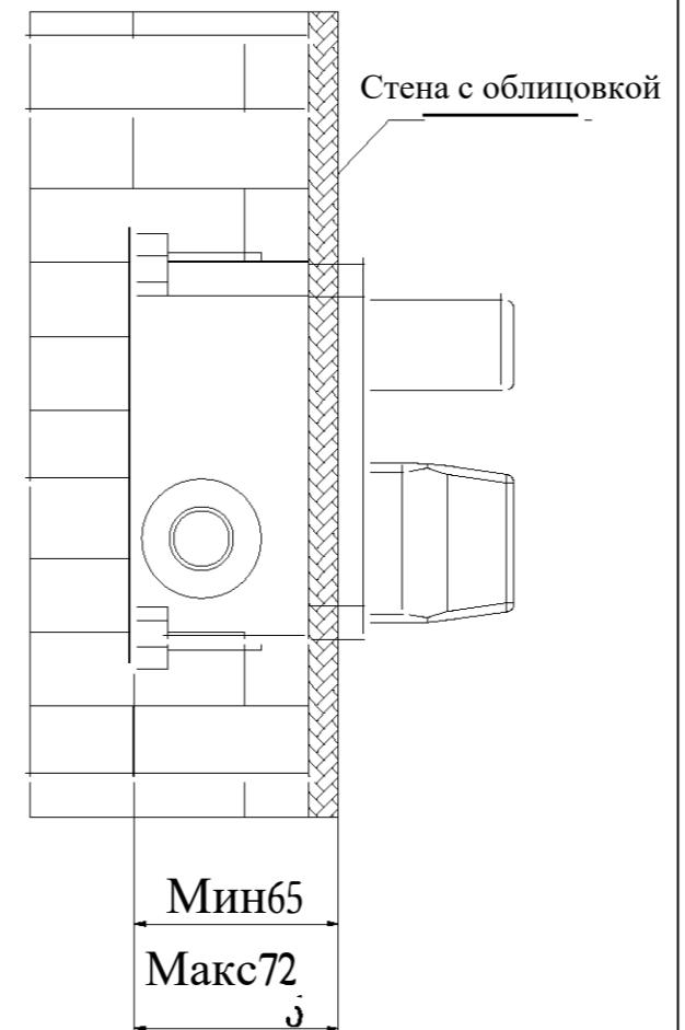
Вставьте дивертор смесителя в выемку до упора и закрутите, чтобы плотно прижать к фиксирующему винту. Нажмите на регулятор и поверните до характерного щелчка.
