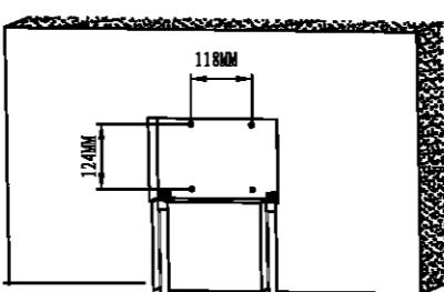
2. В соответствии с указанными на схеме измерениями, просверлите в стене 4 отверстия диаметром 10 мм.
