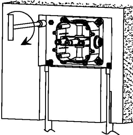
5. Поместите уплотнительное кольцо и прокладку на каждый винт, затем зафиксируйте монтажную коробку гайками с помощью торцового ключа.
