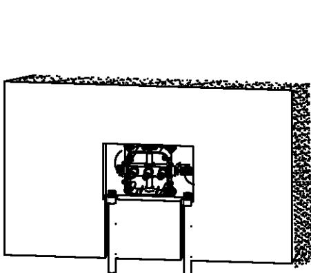
6. Поместите часть герметизирующей прокладки в предварительно смонтированный корпус, а затем затяните соединение трубы подводки.
