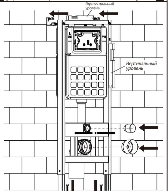
Зафиксировать раму инсталляции к полу и стене
