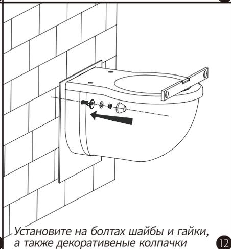
Установите на болтах шайбы и гайки, а также декоративные колпачки 12
