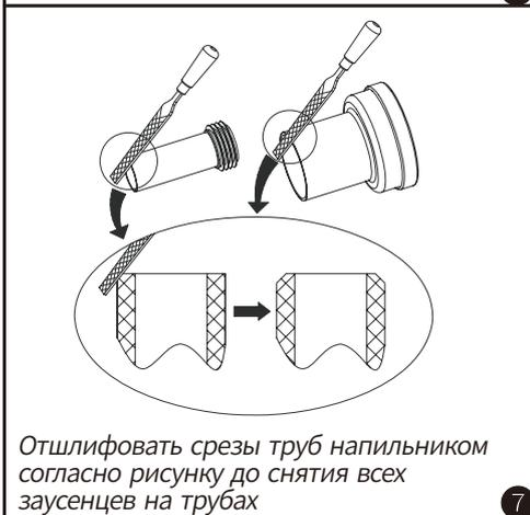
Отшлифовать срезы труб напильником согласно рисунку до снятия всех заусенцев на трубах 7
