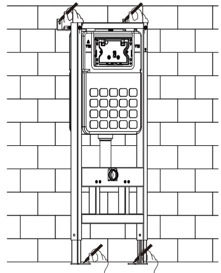
Выровнять по вертикали и горизонтали, сделать разметку под отверстия крепления рамы инсталляции к полу
