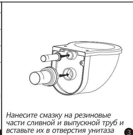
Нанесите смазку на резиновые части сливной и выпускной труб и вставьте их в отверстия унитаза 3
