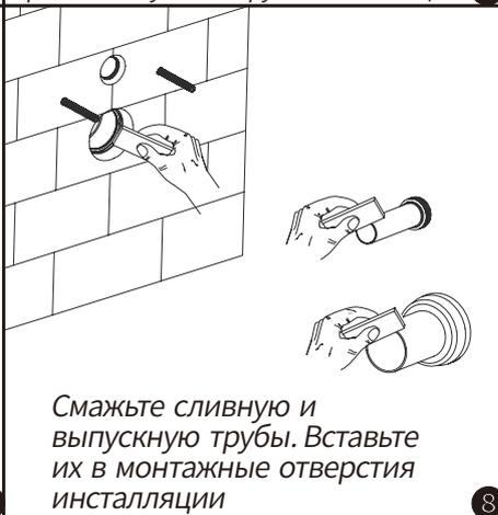
Смажьте сливную и выпускную трубы. Вставьте их в монтажные отверстия инсталляции 8
