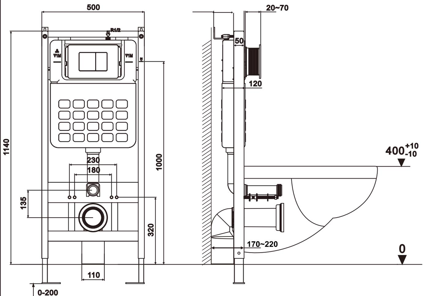
**Примечание:** инсталляция предназначена для установку в стену 170-220 мм и с внешней декоративной обшивкой 20-70 мм.
