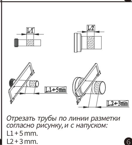
Отрезать трубы по линии разметки согласно рисунку, и с напуском:
