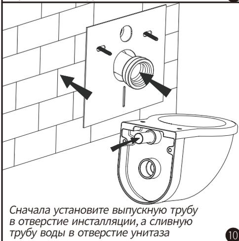
Сначала установите выпускную трубу в отверстие инсталляции, а сливную трубу воды в отверстие унитаза 10
