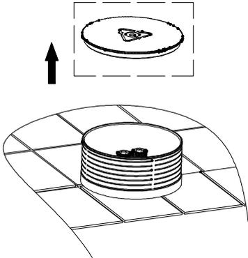
2. Снимите пластину и заглушку с помощью шестигранного ключа
