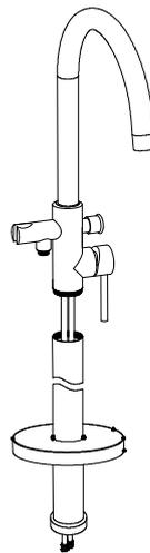
6. Соедините трубку с пластиной, закрутите винты шестигранным ключом
