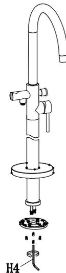
7. Вставьте впускные трубки в соответствующие отверстия встраиваемой коробки. Отрегулируйте положение излива. Подсоедините пластину к встраиваемой коробке с помощью винтов.
